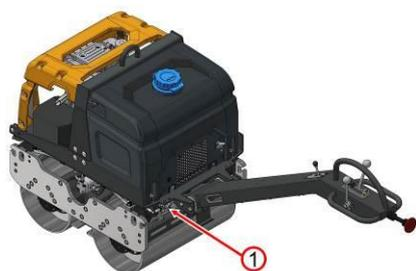
A máquina está equipada com um sistema de rega com água 1.
