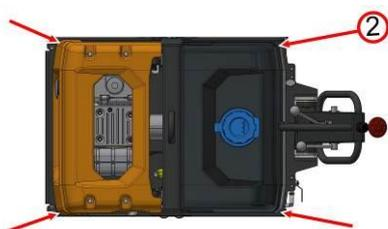
2. Utilize apenas os pontos de fixação previstos (**2**) para fixar a máquina.
