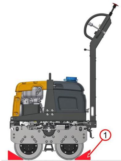
1. Sécurisez la machine contre tout mouvement involontaire, par exemple en plaçant des cales **1**.
