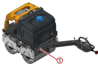
La machine est équipée d'un système d'irrigation d'eau 1.
