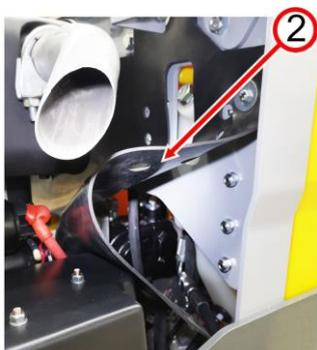
3. Pliez le couvercle en caoutchouc **2** sur le côté.
