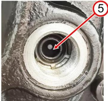
6. Enfoncez les vis Allen à ressort 5 et tournez d'un demi-tour dans le sens des aiguilles d'une montre.
