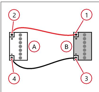
1. Retirar la cubierta de la batería de arranque **A** y las tapas de los polos de la batería de asistencia **B**.
