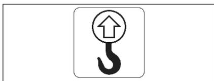
Levantar la máquina únicamente desde el soporte central con el equipo de elevación certificado y los elementos de sujeción (gancho de carga de seguridad).
