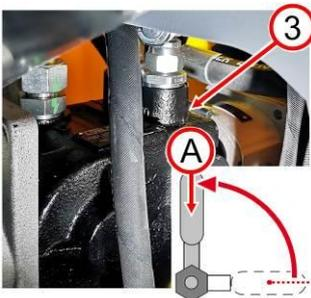
4. Colocar la palanca 3 de la bomba hidráulica en la posición A.
