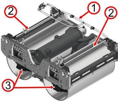
Las mangueras **1** y las barras de riego **2** obstruidas o sucias evitan el riego de los tambores **3** con agua.
