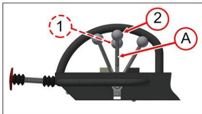
3. Colocar la palanca de aceleración **3** en la posición **A**.
