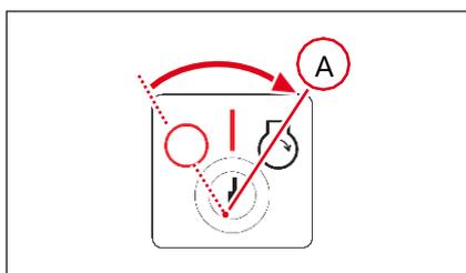
1. Colocar la llave de contacto en la posición **A** y mantener.
