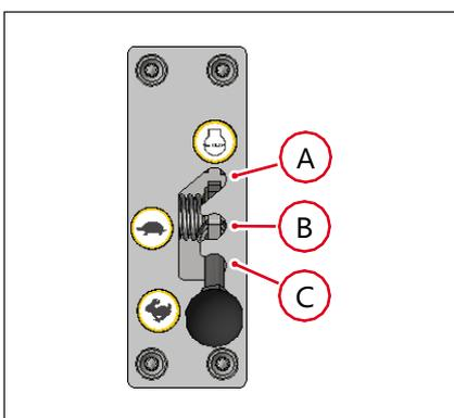
3. Colocar la palanca de aceleración en la posición **A**.
