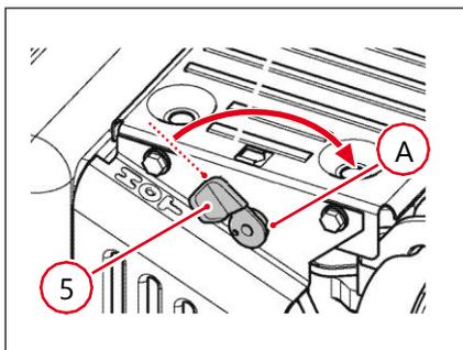
5. Con el motor frío, colocar el estrangulador **5** en la posición **A**.
