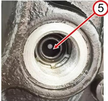
6. Presionar los tornillos Allen pretensados por resorte 5 y girar media vuelta hacia la derecha.
