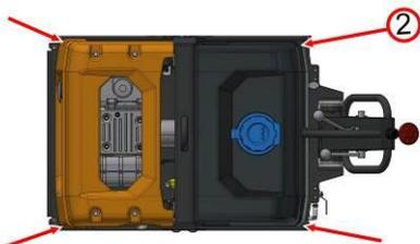
2. Solo utilizar los puntos de amarre previstos **2** para asegurar la máquina.
