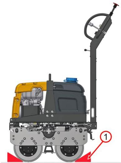
1. Colocar las cuñas **1** delante y detrás de cada tambor y asegurarlas (p. ej., mediante clavos).
