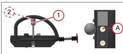
1. Colocar la palanca del vibrador **1** en la posición **A**.
