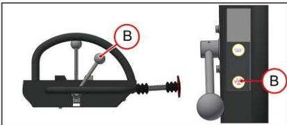
Posición **B**: Vibración en movimiento.
