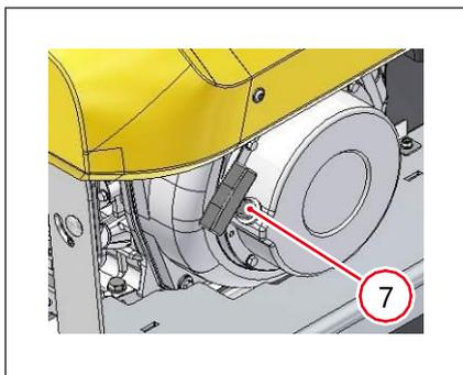
6. Colocarse junto a la máquina, extender lentamente el arrancador de retroceso **7**.
