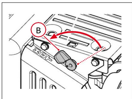
8. Si el estrangulador está accionado, colocarlo en la posición **B** luego de 3 segundos.
