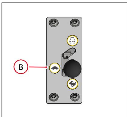
3. Colocar la palanca de aceleración en la posición **B**.
