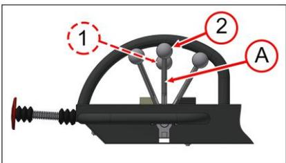
2. Colocar la palanca de marcha **2** en la posición **A**.
