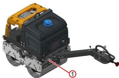
La máquina está equipada con un sistema de riego por agua 1.
