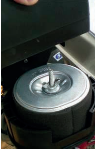
1 RETIREZ LE COUVERCLE DU FILTRE
