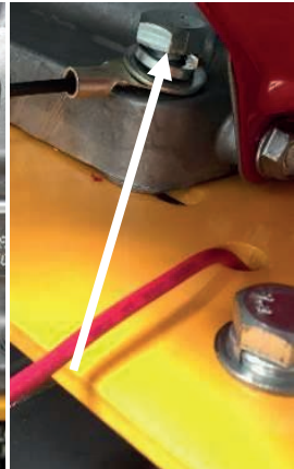
3 RACCORDER LA MISE À LA TERRE À LA VIS DU MOTEUR
