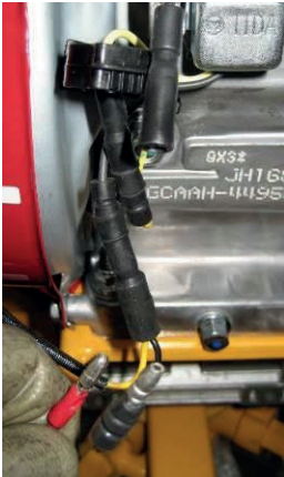
1 DESCONECTAR EL CABLE NEGRO DE LA BUJÍA
