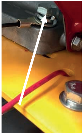
3 CONECTE O ATERRAMENTO AO PARAFUSO DO MOTOR
