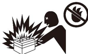
En utilisant une batterie avec un faible niveau d'électrolyte, l'intérieur de la batterie se détériore rapidement, réduisant non seulement sa durée de vie utile, mais provoquant également une explosion. Remplissez l'électrolyte jusqu'à ce qu'il atteigne le niveau intermédiaire entre "UPPER LEVEL" et "LOWER LEVEL". (Dans les batteries où l'électrolyte peut être rechargeé).
