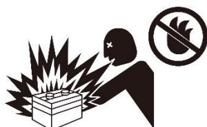
Usar a bateria com baixo nível de eletrólito, o interno da bateria se deteriora rapidamente não só encurtando sua vida útil, mas também pode causar uma explosão. Encha o eletrólito até atingir o nível médio entre "NÍVEL SUPERIOR" e "NÍVEL INFERIOR". (Em baterias em que o eletrólito pode ser recarregado).
